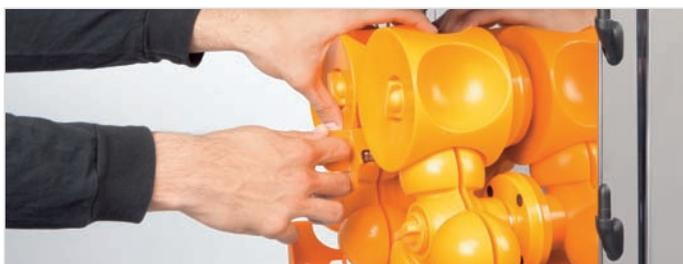
4. Desmontamos la cuchilla tirando del asa hacia nosotros.
