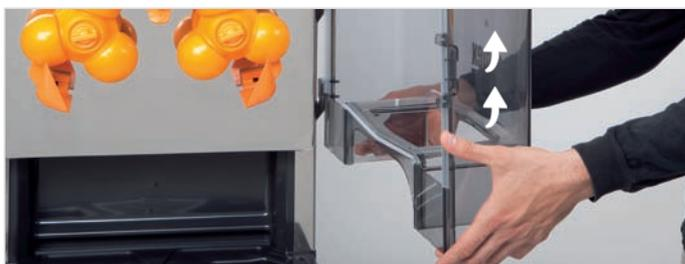
3. Desmontamos la cubierta delantera.
